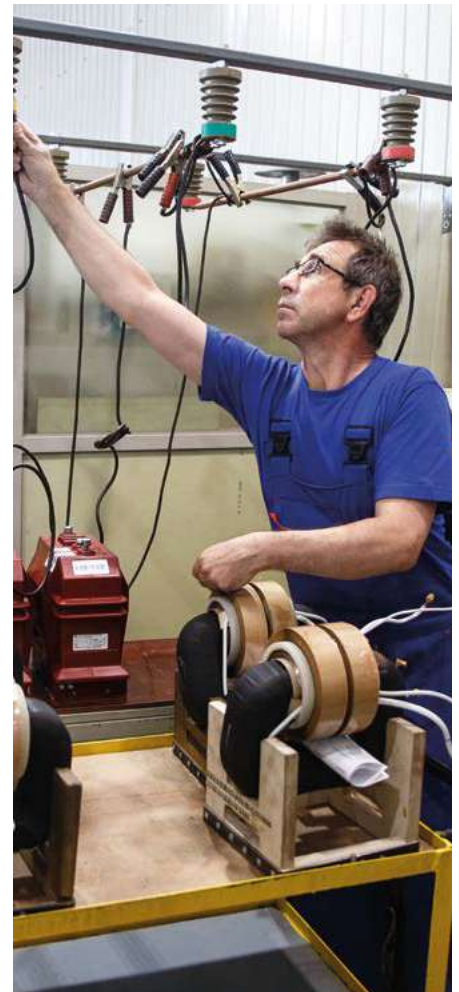
Рис. 6. Трансформатор напряжения НОЛ-НТЗ-35 с номинальным напряжением первичной обмотки 27,5 кВ
